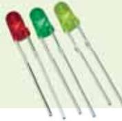
**LED** Eine Leuchtdiode ist eine kleine Lampe, die Strom in Licht umwandelt. Sie arbeitet besser und länger als eine Glühlampe. In ihrem Innern befindet sich ein spezieller Chip aus einem Stoff, den man Halbleiter nennt. Je nach Material des Halbleiters leuchtet das Lämpchen in verschiedenen Farben oder es gibt weißes Licht ab.
